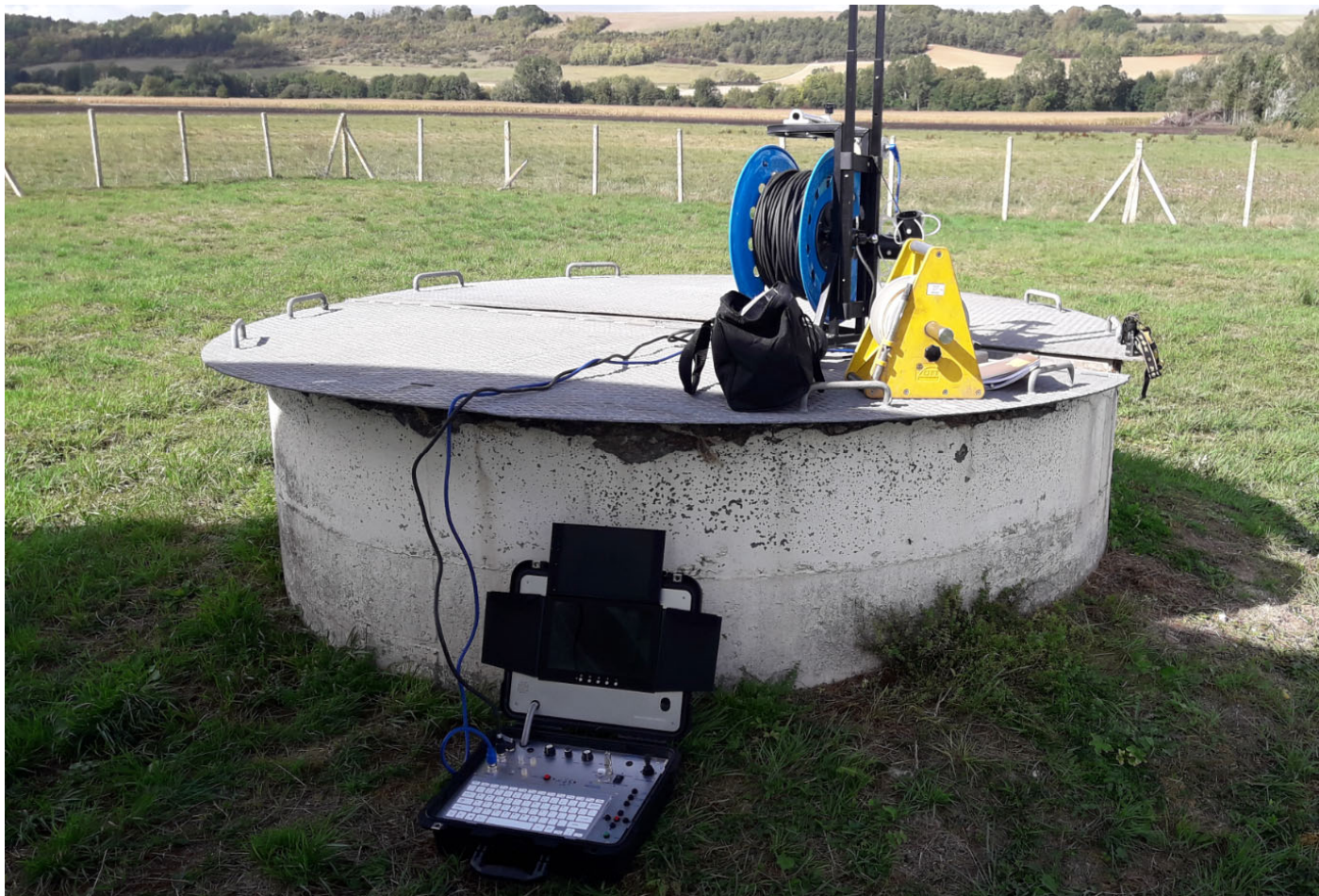
Figure 6 : mise en place de la caméra dans le forage.
