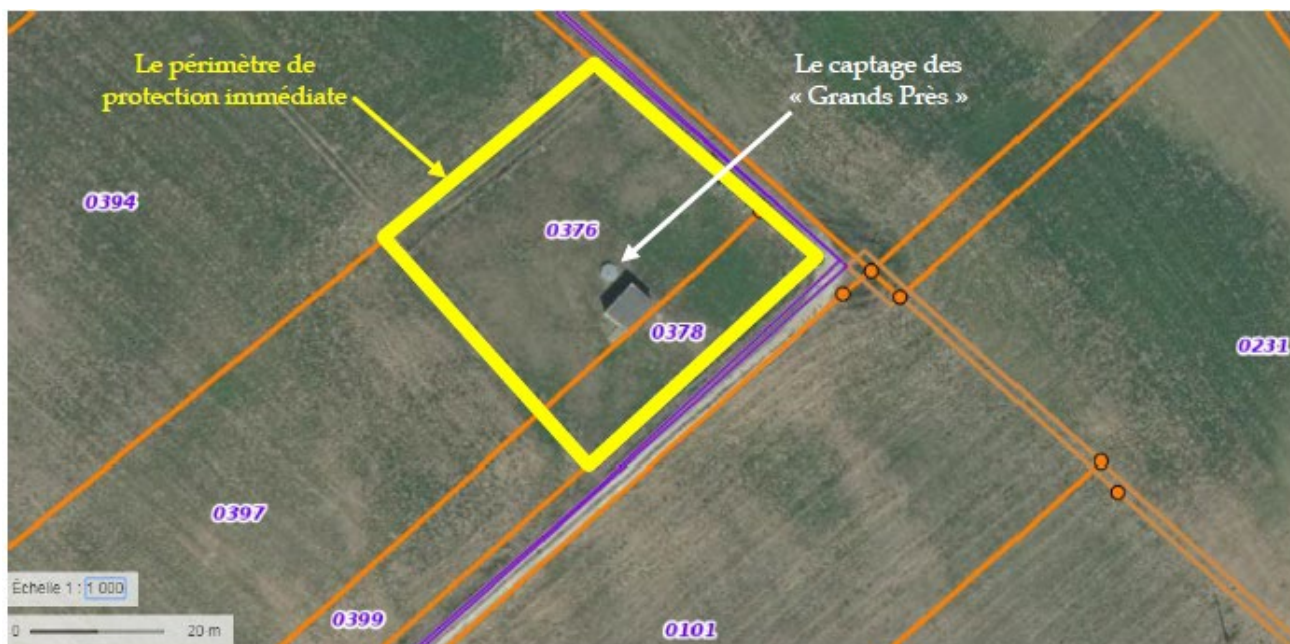
Figure 47: périmètres de protection immédiate du captage des Grands Prés, d'après le rapport de l'hydrogéologue agréé.
